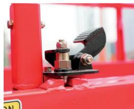
Pedalverriegelung des Plattformausschubs
