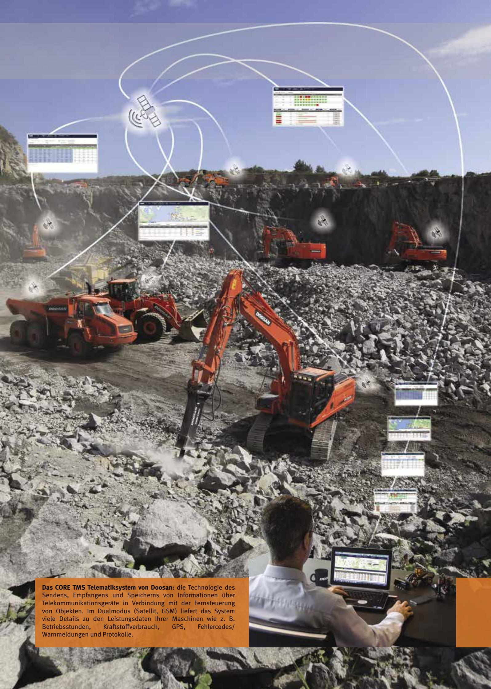
**Das CORE TMS Telematiksystem von Doosan:** die Technologie des Sendens, Empfangens und Speicherns von Informationen über Telekommunikationsgeräte in Verbindung mit der Fernsteuerung von Objekten. Im Dualmodus (Satellit, GSM) liefert das System viele Details zu den Leistungsdaten Ihrer Maschinen wie z. B. Betriebsstunden, Kraftstoffverbrauch, GPS, Fehlercodes/Warmmeldungen und Protokolle.
