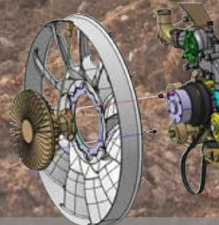
**Elektronische Visco-Lüfterkupplung:** Zur optimalen Kühlung wird die Lüfterdrehzahl über eine Visco-Kupplung gesteuert, wodurch der Geräuschpegel des Lüfters und der Kraftstoffverbrauch sinken.
