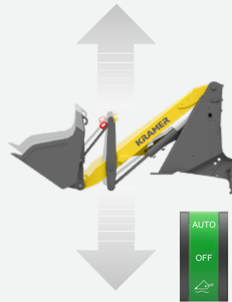
Automatischer Laststabilisator verhindert ein Aufschaukeln der Maschine und reduziert Materialverlust.
