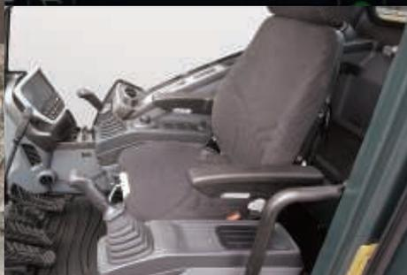
◀ Der HX220AL verfügt serienmäßig über einen **luftgefederten beheizbaren Sitz**. Die **ergonomischen Joysticks** ermöglichen eine komfortable, intuitive Bedienung.
