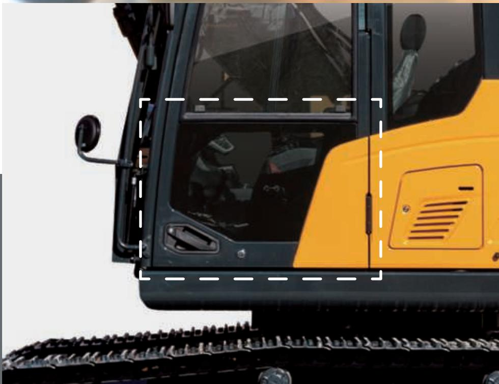
Die **automatische Sicherheitssperre** verhindert ein versehentliches Anlassen des Motors. Während der Aktivierung der automatischen Sicherheitssperre wird der Bagger nicht über den RCV-Hebel gesteuert.
