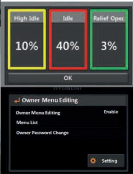
▶ Die **Instrumententafel** ist für schnellen, einfachen Zugriff auf Maschinenstatusinformationen während der Arbeit optimiert. Sie enthält einen leicht ablesbaren **8"-Touchscreen**.
