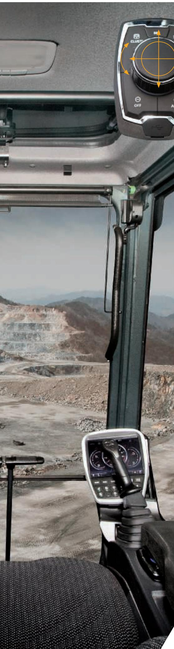
◀ Beschleunigungsfunktion, Fernbedienung der Klimaanlage, und Kombiinstrument können mit der praktischen **haptischen Jog-Shuttle-Steuerung** bedient werden.
