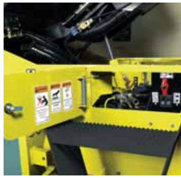
Klappbare Fahrerkabine für eine sichere und einfache Wartung und Instandhaltung
