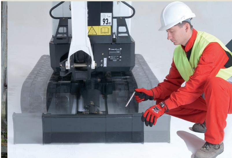
Sowohl der E08 als auch der E10 werden in Serienausrüstung mit einem aus- und einfahrbaren Unterwagen ausgeliefert. Die Schildverlängerungen müssen nicht demontiert und anschließend wieder montiert werden.
