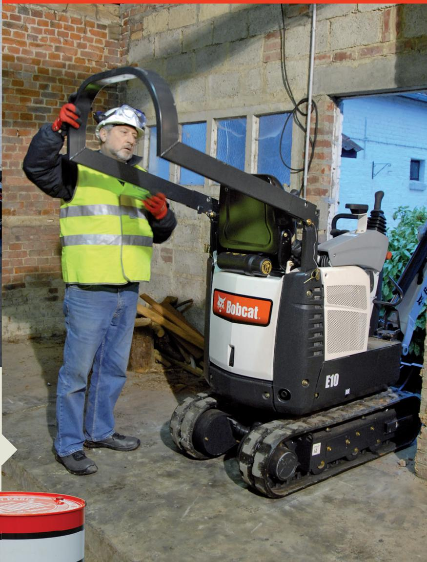
Beide Modelle haben einen aufklappbaren TOPS-Kabinenaufbau.
