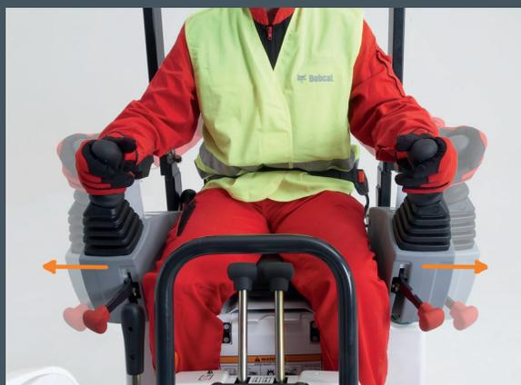
Die einzigartigen einstellbaren hydraulischen Joysticks des E10 sorgen für unvergleichlichen Fahrerkomfort.
