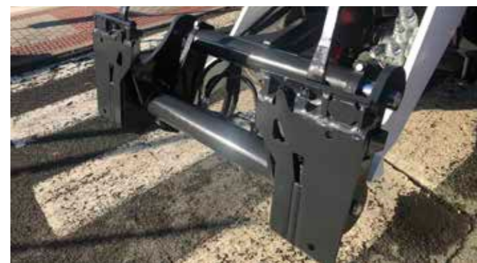
Adapter von Quick-Tach™ auf Bob-Tach™ (für alle Anbaugeräte erforderlich, außer Schaufeln und Palettengabeln)
