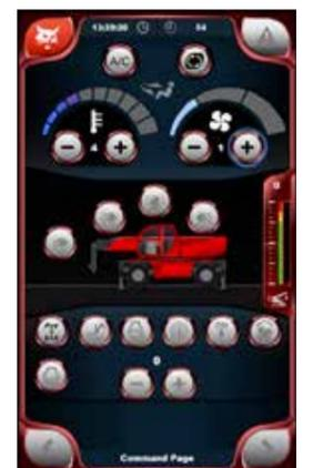
Alle nützlichen Bedienelemente zentral auf einem Bildschirm: Lüftung, Heizung, Klimaanlage, Leuchten, Funkfernsteuerung, Drehkransperre und weitere.
