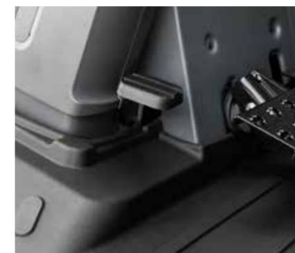
Besonders einfaches Ein- und Aussteigen dank der rasch per Pedal verstellbaren Lenksäule
