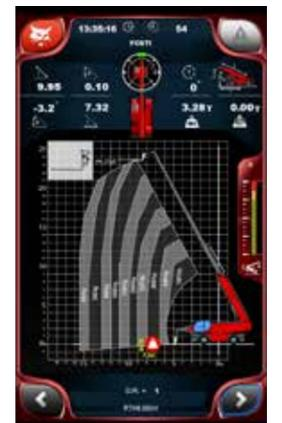
Das RFID-System erkennt Ihr Anbaugerät automatisch und gibt ein dynamisches Lastdiagramm aus, in dem Sie die Bewegung der Lasten anhand der Auslegerbewegungen verfolgen können. Außerdem werden das aktuelle Lastgewicht und die maximale Hubkraft in der aktuellen Position ausgegeben.
