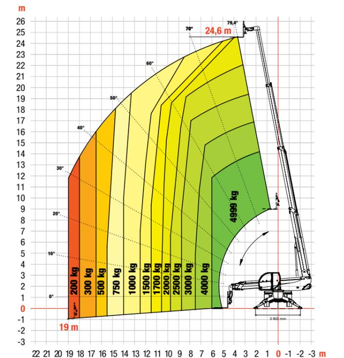
Lastdiagramme mit Lastschwerpunkt bei 500 mm bis zu 4999 kg Nutzlast und 600 mm
