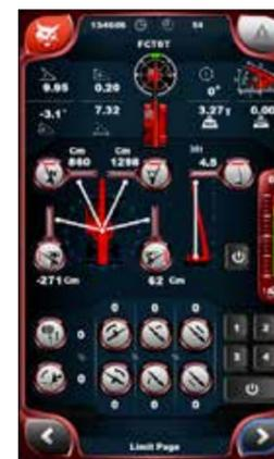
Auf dieser Seite können Sie mit vier virtuellen Wänden (links, rechts, vorne, oben) einen Arbeitsbereich definieren, in dem die Maschine sicher arbeiten kann. Auch alle Ausleger- und Drehgeschwindigkeiten können hier eingestellt werden.
