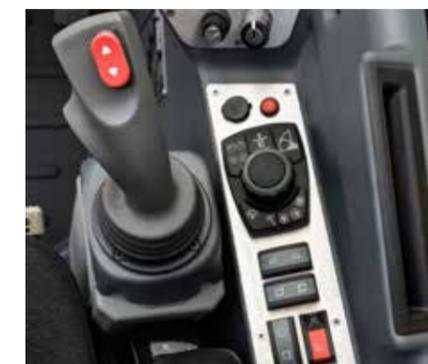
Alle Bedienelemente für Stabilisierung und Rahmenausgleich sind auf der Konsole neben dem Seitenfenster übersichtlich angeordnet.
