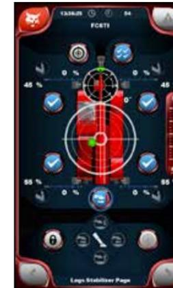
Die vier Stabilisatoren lassen sich einzeln oder simultan steuern. Dabei haben Sie ihre Position immer im Blick. Mithilfe des automatischen Niveaueingleichs können sie schnell und einfach auf dem Boden platziert werden.
