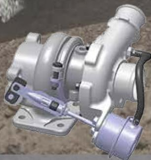
**Turbolader mit Ladedruck-Regelventil:** Ermöglicht ein Umleiten der Abgase vom Turbinenrad weg, damit der Ladedruck optimaler geregelt werden kann und der Motor geschützt wird. Dies verringert auch die Zeitverzögerung, bevor der Turbolader das maximale Drehmoment erzeugt, und verringert den Verschleiß bei hohen Drehzahlen und geringer Belastung. Turbolader erhöhen die Luftdichte, so dass der Motor auch in großen Höhen mehr Leistung erzeugt.
