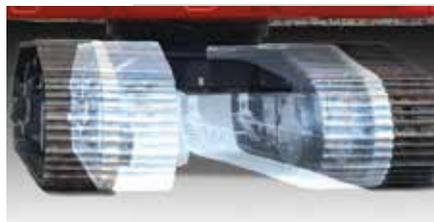
**Verfügbare Unterwagen:** DX340LC-5-Unterwagen schmal/Standard: 3,00/3,28 m mit 600-mm-Stegen. DX380LC-5-Unterwagen schmal/Standard: 3,00/3,35 m mit 600-mm-Stegen.
