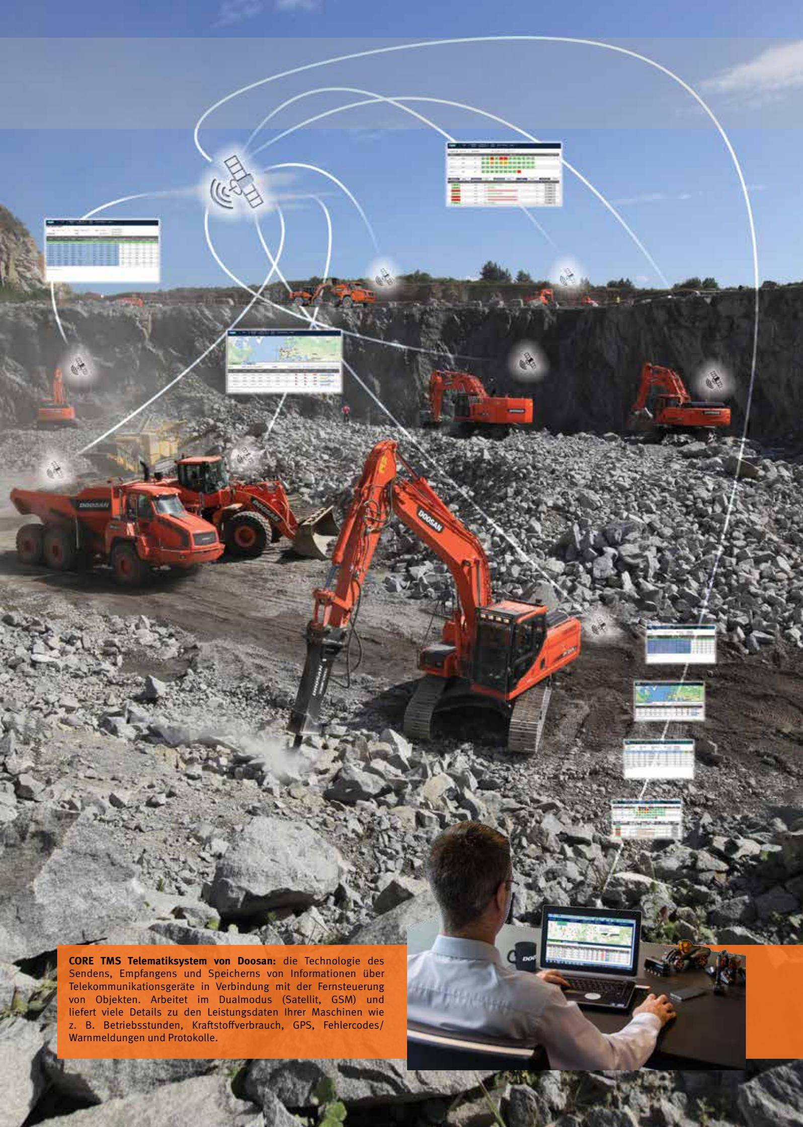
**CORE TMS Telematiksystem von Doosan:** die Technologie des Sendens, Empfangens und Speicherns von Informationen über Telekommunikationsgeräte in Verbindung mit der Fernsteuerung von Objekten. Arbeitet im Dualmodus (Satellit, GSM) und liefert viele Details zu den Leistungsdaten Ihrer Maschinen wie z. B. Betriebsstunden, Kraftstoffverbrauch, GPS, Fehlercodes/ Warmmeldungen und Protokolle.
