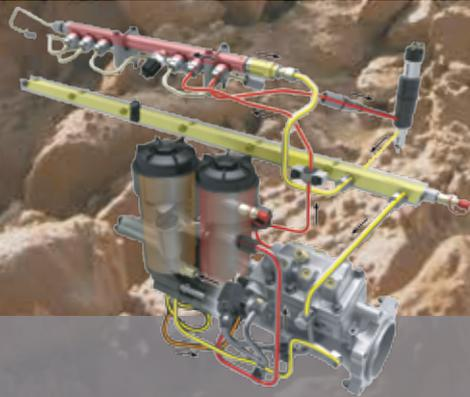
**XPI Common-Rail-Kraftstoffeinspritzung:** Kraftstoffzufuhr und Einspritzdruck können unabhängig von der Motordrehzahl eingestellt werden. Dieses System passt sich kontinuierlich an veränderte Drehzahlen an, sodass Sie jeden Tropfen Diesel größtmöglich nutzen.
