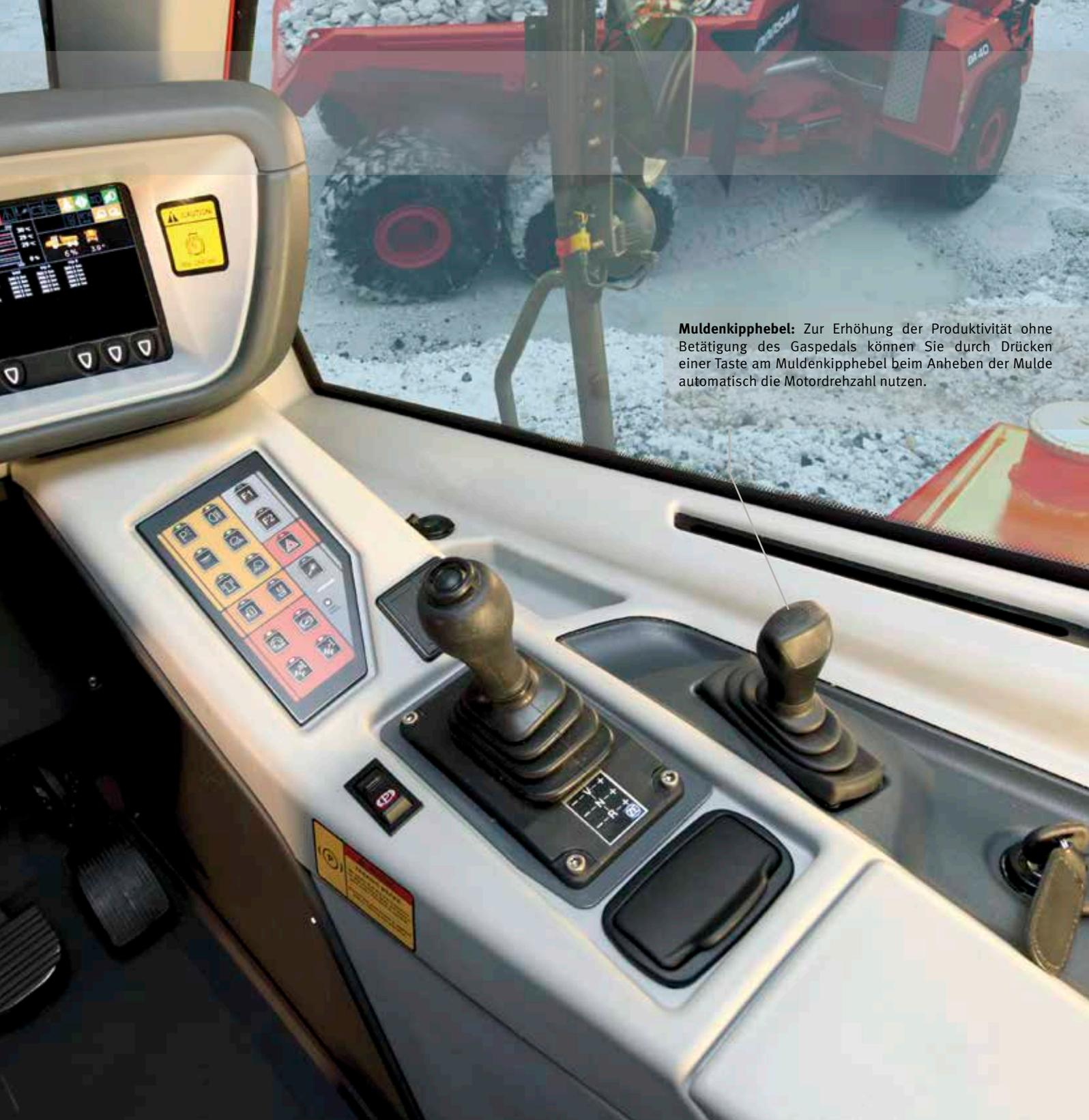
**Muldenkipphebel:** Zur Erhöhung der Produktivität ohne Betätigung des Gaspedals können Sie durch Drücken einer Taste am Muldenkipphebel beim Anheben der Mulde automatisch die Motordrehzahl nutzen.
