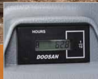
Betriebsstundenzähler (vom Boden aus ablesbar)
