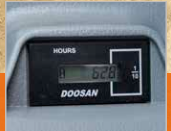
Betriebsstundenzähler (vom Boden aus ablesbar)
