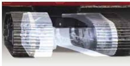
**Unterwagen erhältlich:** DX380LC-5-Unterwagen schmal/Standard: 3,00/3,35 m mit 600-mm-Stegen.
