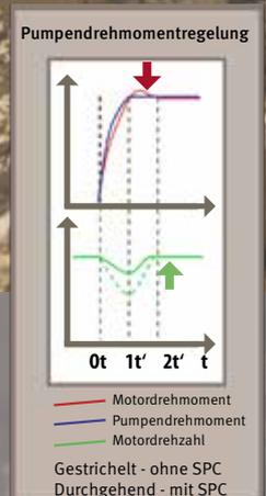
**SPC (Smart Power Control):** zwei Systeme (variable Drehzahlregelung und Pumpendrehmomentregelung), die zusammen den Wirkungsgrad erhöhen und dabei gleichzeitig die Produktivität aufrechterhalten.
