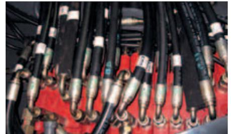
**Haupthydraulikventil:** Die Bewegungen der Maschine können einzeln oder simultan sehr feinfühlig gesteuert werden. Die optimale Abstimmung der Hydraulikfunktionen untereinander und ein Sperrventil im Hubzylinderkreis unterstützen den Fahrer im schwersten Einsatz.
