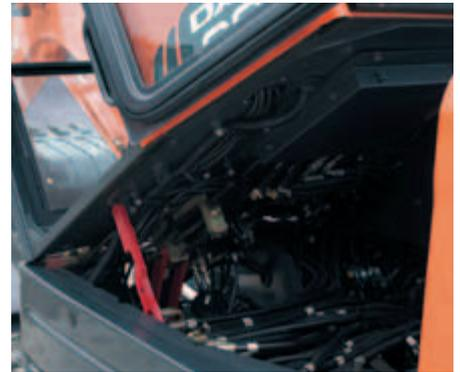
**Kippbare Kabine:** einfacher Zugang bei Wartungsarbeiten.
