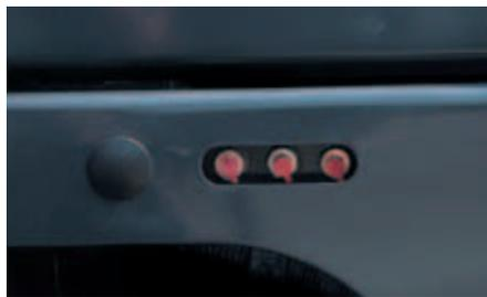
**Schmierstellen:** Zentralisierte Schmierstellen für Schwenkbock und Zylinder.
