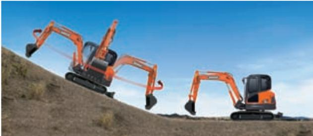
**Höhere Steigfähigkeit und Arbeitskapazität:** Dank des starken Fahntriebendes, basierend auf der hohen Motorleistung und dem hohen Schwenkmoment hat der DX80R immer noch Reserven bei Arbeitseinsätzen am Hang.
