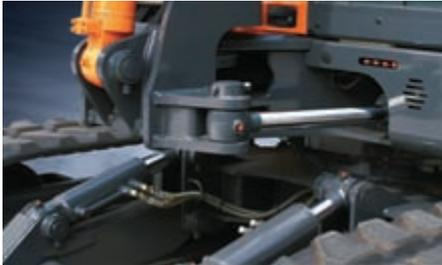
**Schwenkausleger:** Die neu konstruierte Schwenklagerung und die Schwenkzylindergröße garantieren eine hohe Standfestigkeit.
