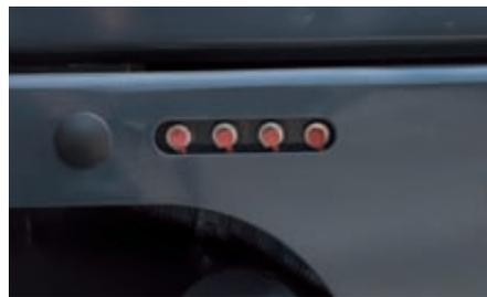
**Schmierstellen:** Zentralisierte Schmierstellen für Schwenkbock und Zylinder.
