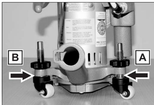
Abb. 79 Die Maschine schleift zu weit **links**:
