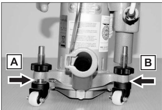
Abb. 77 Die Maschine schleift zu weit **rechts**:
