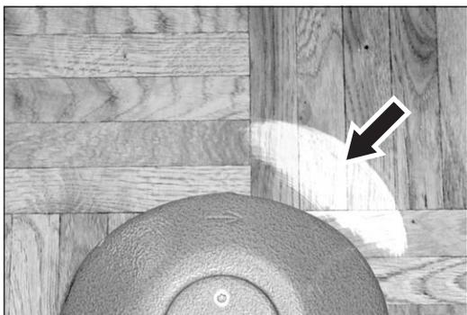
Abb. 76 **Falsche** Einstellung der Lenkrollen:
