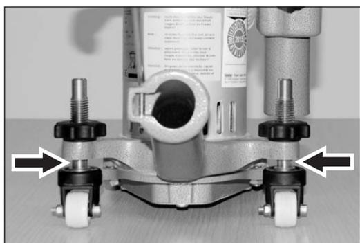
Abb. 67 Einstellung der Lenkrollen für den langen Vorsatz.
