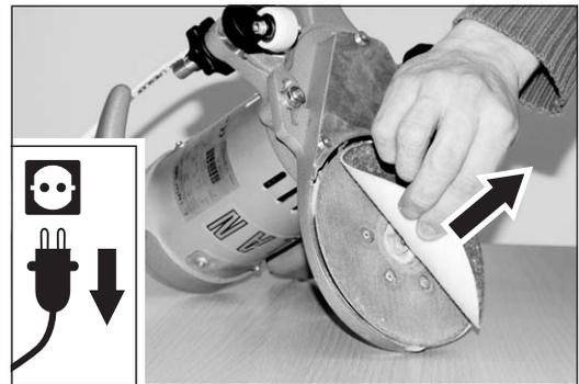
Abb. 21 Die Klettschleifscheibe vom Schleifteller abziehen.
