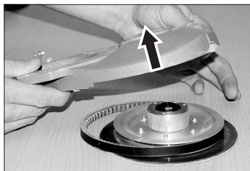
Abb. 40 Den Vorsatz von dem kompletten Schleifteller abnehmen.
