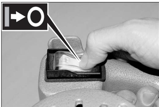
Abb. 12 Ausschalten der Maschine am Wippenschalter.
