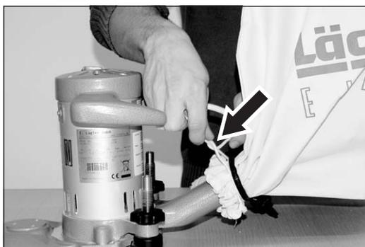
Abb. 7 Den Staubsack mit einer Schleife zubinden.
