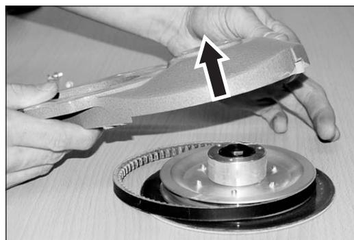
Abb. 50 Den Vorsatz von dem kompletten Schleifteller abnehmen.
