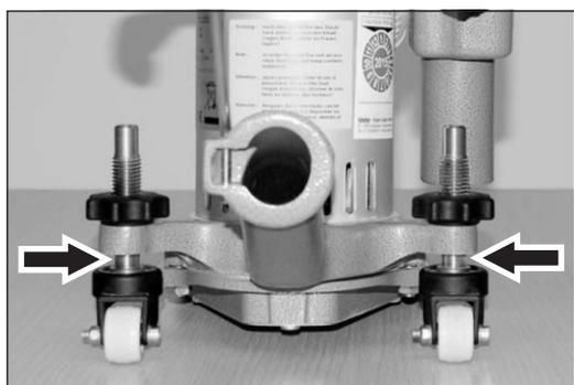
Abb. 70 **Steile** Maschineneinstellung für **grobe** Schleifarbeiten.
