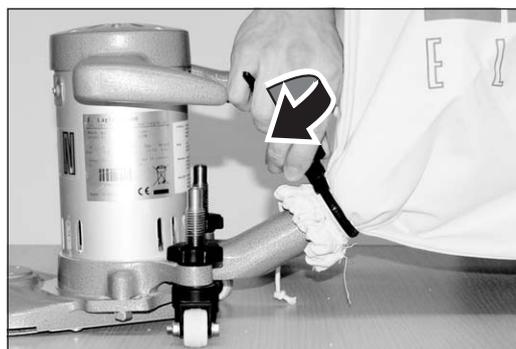
Abb. 8 Die Mutter am MultiClip handfest anziehen.
